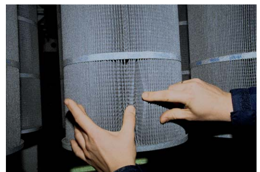
Volle Nutzung der Filterfläche (Gasturbinen-Zuluffiltration in Chemie-Werk mit GTC 327)
